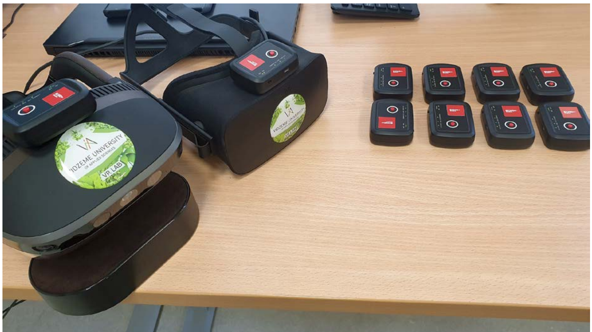
Pozīcijas izsekošanas sensori ar virtuālās un papildinātās realitātes galvas displejiem.
